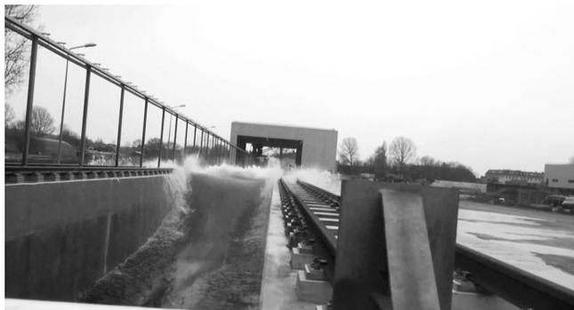
荷兰科学家制造出了世界上最大的人工波浪，这是一个庞大项目的一部分，其目标是保护荷兰免受洪水的困扰。目前最高的人工波浪高度仅有5米出头，但在这座刚刚建成的、价值2600万欧元的设施中，工程师们希望能制造出更大的波浪。该设施被称为“三角洲水槽”（Delta Flume），具有900万升的容量，来自水库的水能以每秒1000升的速度注入其中。通过将水体来回推向一座10米高的钢铁墙，科学家可以制造出不同的人造波浪，从碎浪到汹涌的巨浪，甚至可以制造出单独的海啸波。
