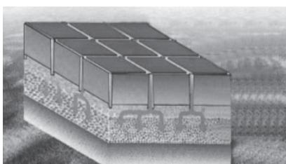
充地下水、调节水循环;在干旱缺水时有条件将蓄存的水释放出来,并加以利用,从而让水在城市中的迁移活动更加“自然”。“海绵城市”突破了传统的“以排为主”的城市雨水管理理念,以建筑与小区、绿地与广场、城市道路、城市水系等各种城市基础设施为载体,充分考虑城市基础设施安全运行和城市水安全的问题、水文条件的差异性、规划指标及项目操作的可行性,并综合利用渗、滞、蓄、净、用、排等多种生态化技术,从而构建起新型的城市低影响开发雨水系统。
