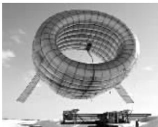
“几十年来,风力涡轮机一直需要起重机和高塔才能进入距地面几百英尺的高度,不过,这一高度的风力较小,同时也不稳定。我们利用现代充气材料将涡轮机送入距地面更高的高度。这项技术适用于所有地区,在成本上具有竞争力同时便于安装。”
