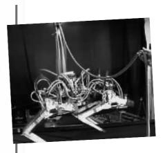
美国国防部高级研究计划署近日宣称,该 机构委托波士顿动力工程公司研制的机器人 "猎豹"以每小时 18 英里(约合每小时 29 公 里)的成绩打破了有腿机器人的陆地步行速度 最高纪录,成为速度最快的四腿机器人。据悉, "猎豹"的目标是步行速度超过人类,成为能够 逃避人类追捕的战场机器人。研究人员介绍: "有腿机器人此前最高步行纪录是每小时 13.1 英里(约合每小时21公里),是由美国麻省理 工学院有腿机器人实验室研制的'平面两足机 器人'所创造的。不过,将来'猎豹'还可能奔跑 得更快,目标时速可达70英里(约合每小时 113 公里)。
