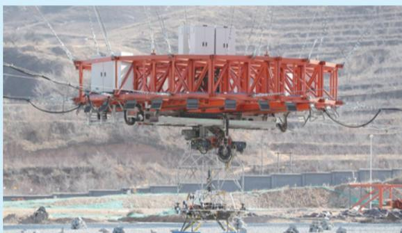
11月14日，我国首次火星探测任务着陆器悬停避障试验在位于河北省怀来县的地外天体着陆综合试验场圆满完成，此次试验是我国火星探测任务首次公开亮相，试验模拟了着陆器在火星环境下悬停、避障、缓速下降的过程，对其设计正确性进行了综合验证。
