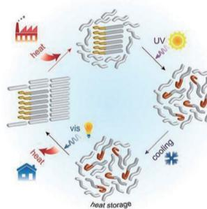
相变材料的潜在应用很有兴趣,当它们从固态变为液态的时候,可以吸收或释放大量的热能(反之亦然)。这项技术能够用于调节建筑的热量、打造“热电池”,甚至在开车上班的路途中让咖啡保持热度。
