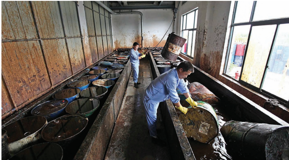
员工正在将收来的地沟油推入热化槽。
