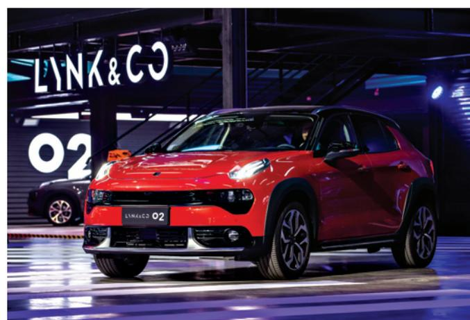
02为19.28元,中间有7万多的差价。从发动机来看,领克02的车型中三缸发动机占领了一席之地,而奔驰GLA搭载的皆为四缸发动机。由于环保趋势,不少车企都为旗下汽车搭载了三缸小排量发动机,虽然技术在不断进步,但在性能上三缸发动机仍有很大提升空间。领克02的1.5TD最大功率达到180马力,最大扭矩达到265牛米,其实这样的参数和市面上的2.0T已经非常接近。领克02将奔驰GLA作为越级对标竞品,体现出领克02的野心。
