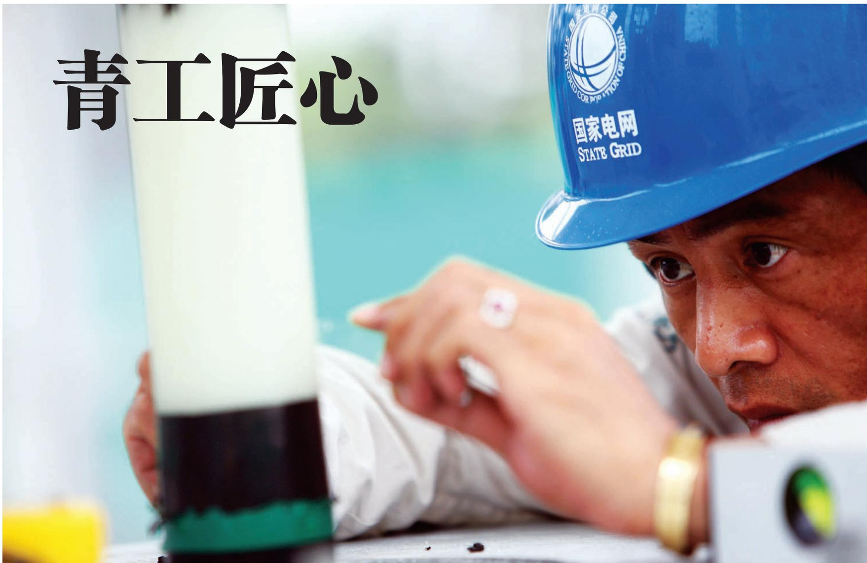
赵斌用玻璃片修正误差,每刮一下的深度都要严密控制在0.01毫米以内。
