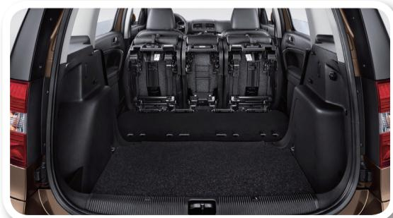
生活是斯柯达造车的初衷，而Yeti延续了斯柯达品牌在空间上一贯的设计优势，无论在驾乘空间还是储物空间上都有出色表现。Yeti拥有长4275mm（带外挂备胎车型长4459mm）、宽1793mm、高1682mm的车身尺寸，轴距为2638mm，宽大的车身尺寸提供了充足的储物和驾乘空间。与此同时，Yeti还提供了独具特色的Varioflex后排座椅自由组合功能，后排座椅分别为三个独立的座椅，两侧座椅前后距离可调，座椅还可按照40/20/40比例进行折叠或者拆卸，打造出多样的空间组合，提高了乘坐舒适性。
