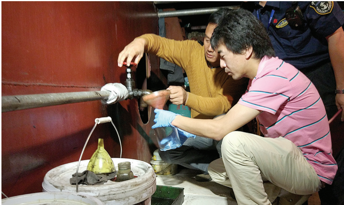
抽检现场,专家正在放油取样。
