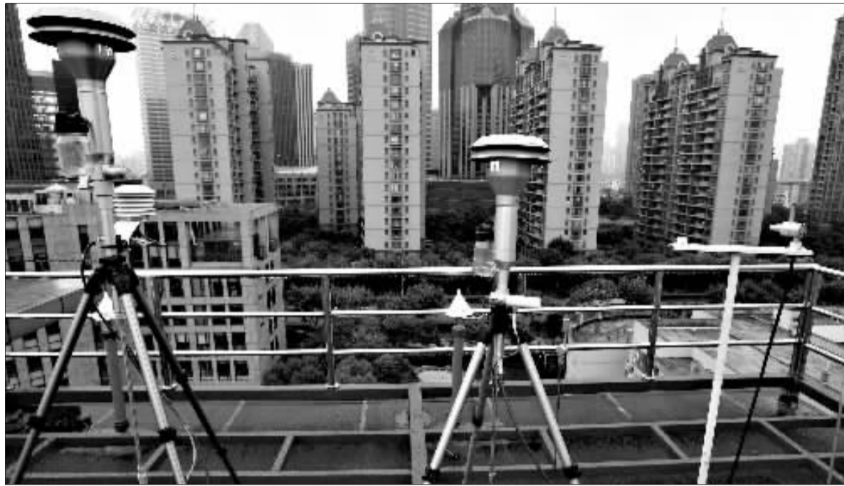
楼顶上监测PM2.5和PM10的设备。
