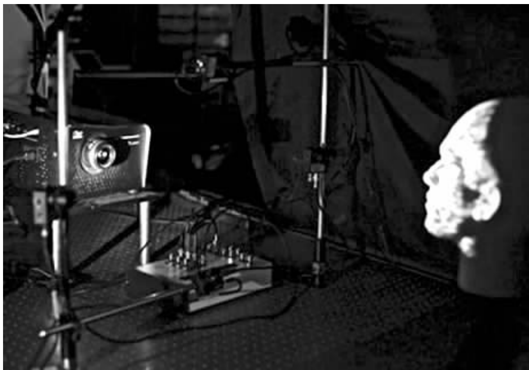
利用2个单像素探测器得到的图像就可以绘制出物体的3D图像。
