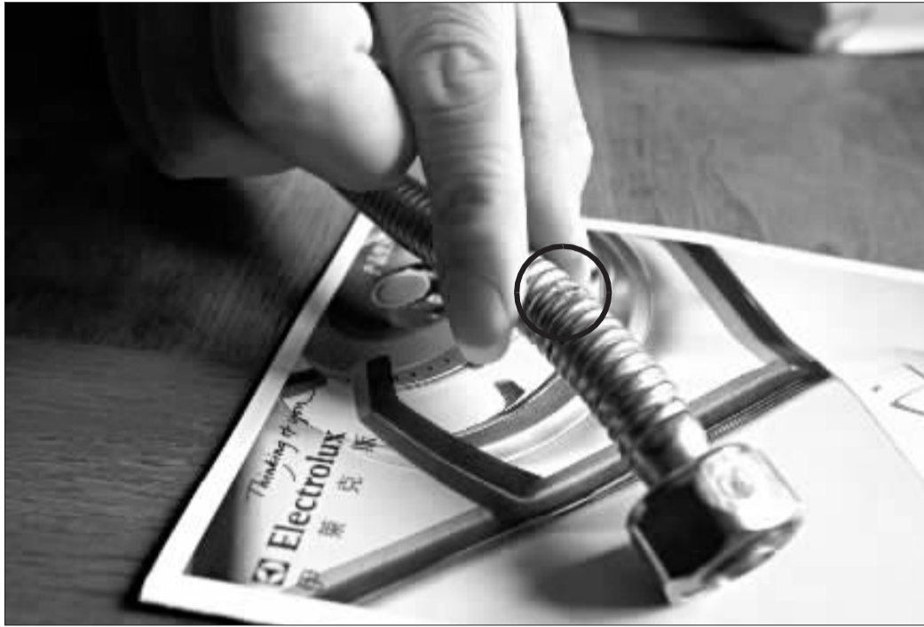
王先生购买的伊莱克斯燃气灶不锈钢软管使用不到两年就出现了破洞。
