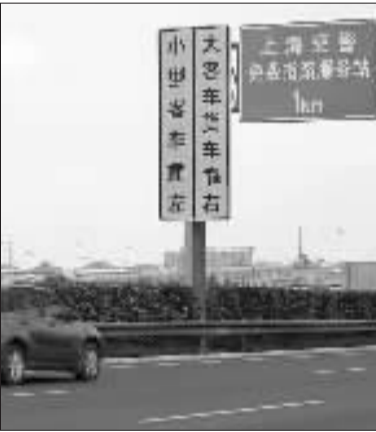
在一、二级保障收费站的上游1000米处、500米处,分设主线分流引导标志牌。
