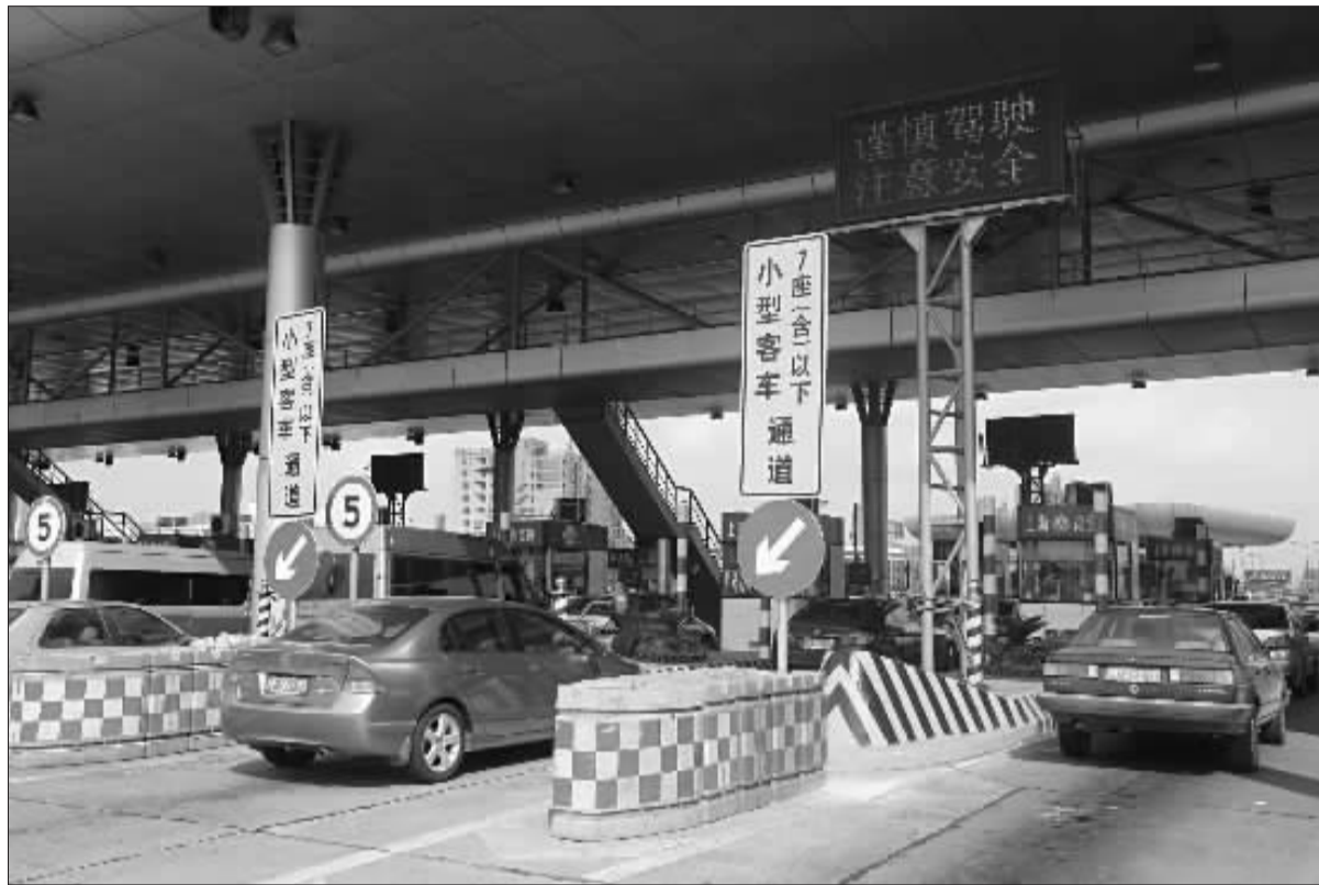
G2江桥收费站内,已设置小型客车专用通道引导标志牌,内容为“7座(含)以下小型客车通道”。
